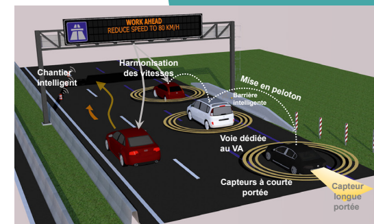
▲ Autoroute hybride munie d'une voie dédiée à la circulation des véhicules autonomes
