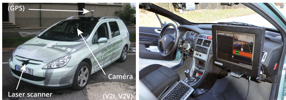
▲ CARLLA : le prototype de l'Ifsttar dédié à l'automatisation de la conduite (projets ABV, Have-it, eFuture, etc.)
